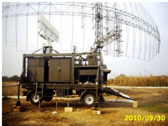
Interogator IFF de mare distanță realizat la AEROSTAR Bacău Conjugat cu radarul sovietic OBORANA-14 (2010)
