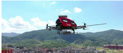
FIG. 25. EHang 216F fire extinguishing drone
