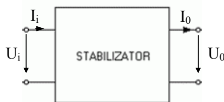
Fig. 6.2. Stabilizatorul privit ca un cuadripol
